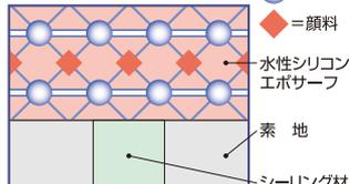
緻密さがシーリング材の粘着性移行を止める。
